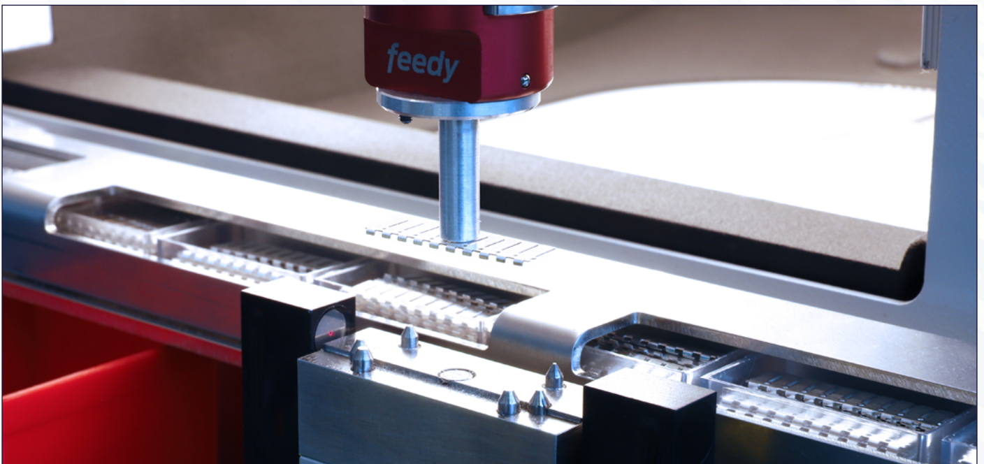
Abb. 4: Automatisierte Bestückung mit Pick-and-Place. Eine Montagehilfe schafft die definierte Greiffläche für den Vakuumsauger und macht das Bauteil prozesssicher zuführbar.
