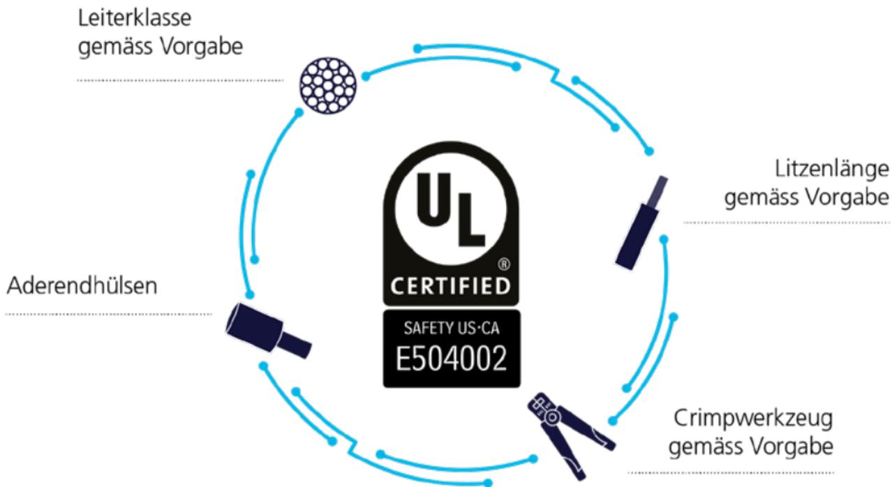
Die Qualität und Sicherheit einer Kabelverbindung nach UL Standard ist nur gewährleistet, wenn die Leiterklasse der Litze, die Länge der Abisolierung und das korrekte Werkzeug gemäss Vorgabe mit der geprüften Aderendhülse verwendet wird.
